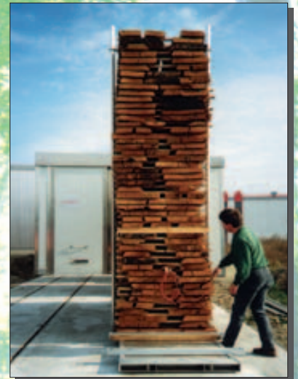
Arriba: carga rápida con vagonetas incluidas en el suministro con tirantes y traversas de aluminio
