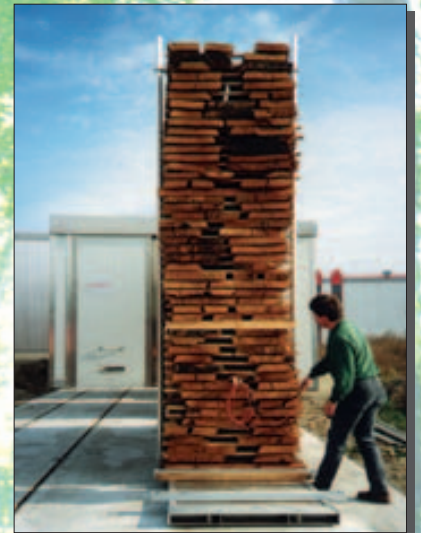
oben: schnelle Beschickung über zugehörige Stapelwagen mit Rungen und Alu-Kanthölzern
