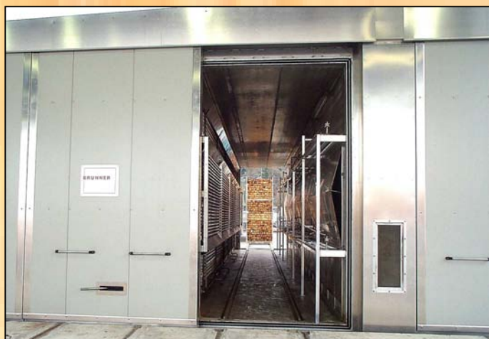
Vakuuntrockner Typ S6/S12, 50 m 3 – 350 m 3 Sechs/Zwölf-Stapel-Anlage 3 Stapel übereinander je Gleis hier Durchfahrbetrieb
